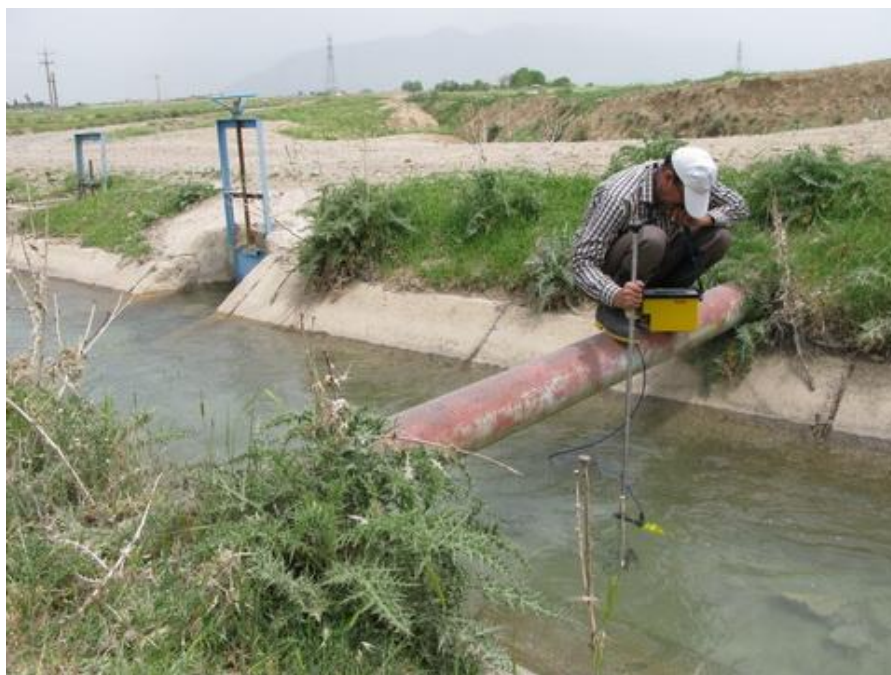
شکل ۱۰- اندازه گیری سرعت آب بوسیله میکرومولینه
